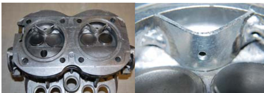
Rys. 4. Widok głowicy z komorą wstępną nr.2 (przed badaniami) Fig. 4. View of cylinder head with prechamber number 2 before testing
