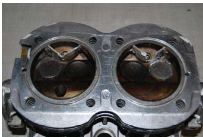
Rys. 11. Widok głowicy z komorą wstępną nr 2 po badaniach Fig. 11. View of cylinder head with prechamber number 2 after testing
