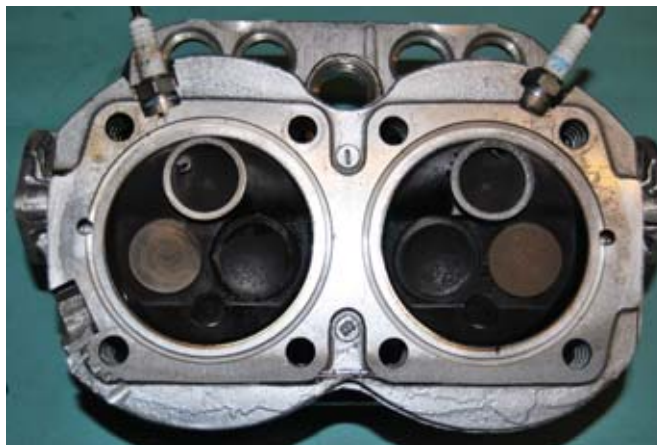
Rys. 10. Widok głowicy z komorą wstępną nr 1 po badaniach Fig. 10. View of cylinder head with prechamber number 1 after testing
