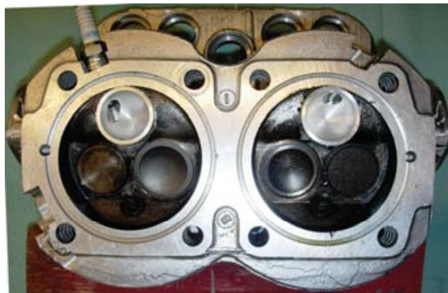
Rys. 3. Widok głowicy z cylindryczną komorą wstępną nr.1 Fig. 3. View of cylinder head with prechamber number 1
